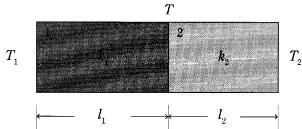
さて、図のように、断面積の等しい二つの棒状の物体が接触して置かれている。物体1、物体2の長さはそれぞれ  $l_1$ [m]、 $l_2$ [m]、熱伝導率はそれぞれ  $k_1$ [W/(m K)]、 $k_2$ [W/(m K)]である。図のように、物体1の左端と物体2の右端の表面温度がそれぞれ  $T_1$ [K]、 $T_2$ [K] ( $T_1 > T_2$ ) に保たれて定常状態にあるとき、両物体の熱接触面の温度  $T$  はいくらか。次の中から正しいものを一つ選べ。ただし、両物体はともに均質で、その周りは断熱材で覆われているものとする。
